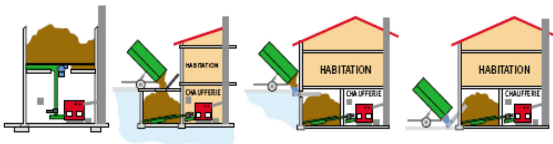
Chaudière automatique granulés et plaquettes.
